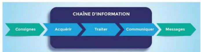
La chaîne d'information est la partie du système automatisé qui capte l'information et qui la traite. On peut découper cette chaîne en plusieurs blocs fonctionnels, sous forme de quatre verbes :
